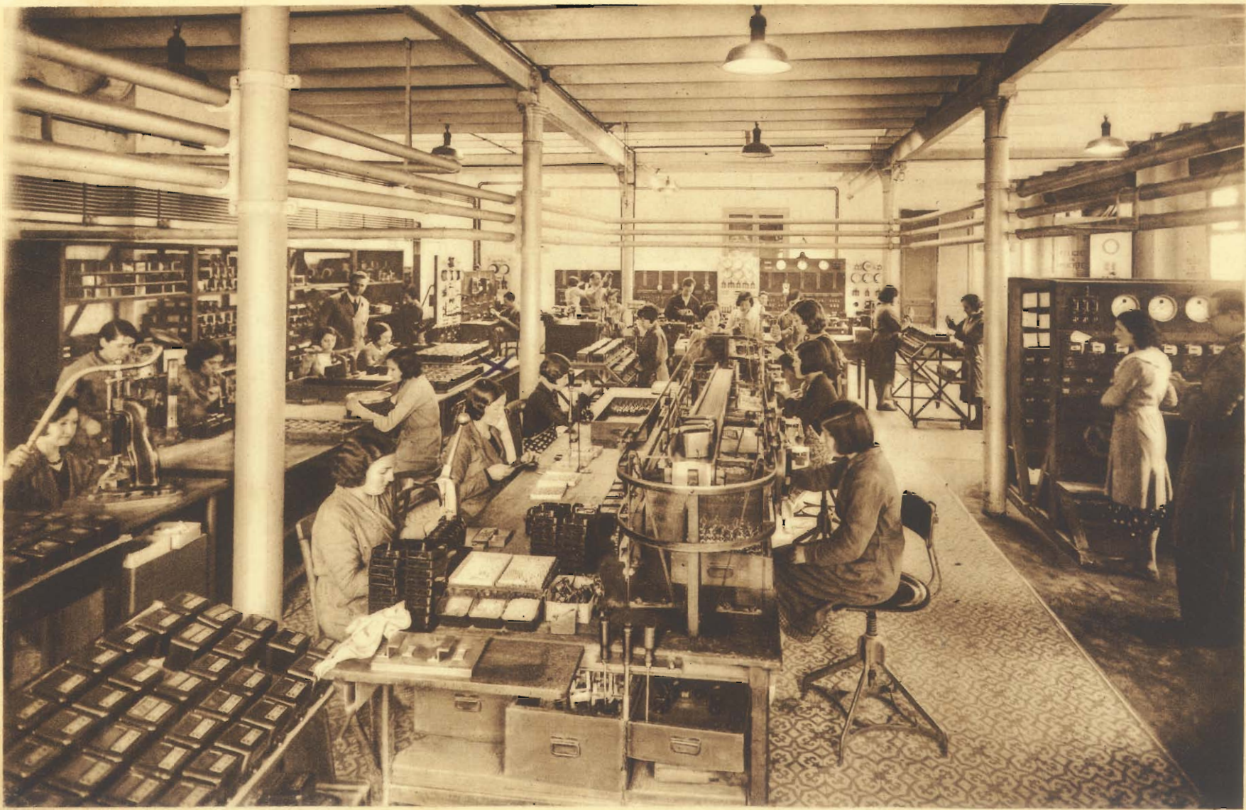
Montaje y verificación de contadores eléctricos.
