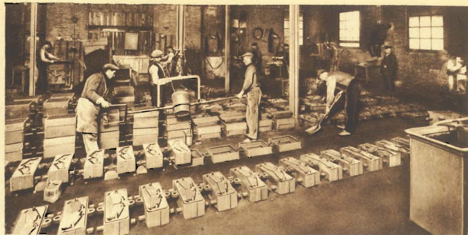
Fundición mecánica para piezas pequeñas.
